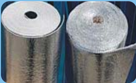
Un exemple d'isolant : les Produits Minces Réfléchissants.
